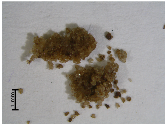
Obr. 17: Makrosnímek vzorku ST13/8954, fotografie ze stereomikroskopu SMZ 800, Nikon, fotografováno v odraženém světle. Na snímku jsou patrná diskrétní zrna křemene, která tvoří součást horniny. Zrna jsou barevně alterovaná do hněda jako důsledek přítomnosti organických složek.
