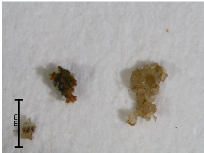
Obr. 15: Makrosnímek vzorku ST12/8953, fotografie ze stereomikroskopu SMZ 800, Nikon, fotografováno v odraženém světle. Na snímku jsou patrná diskrétní zrna křemene, která tvoří součást horniny. Úlomky vzorku jsou výrazně barevně alterované do hněda až červeno-hněda jako důsledek přítomnosti organických složek. Úlomky jsou při smočení vodou výrazně hydrofobní (nesmáčivé).
