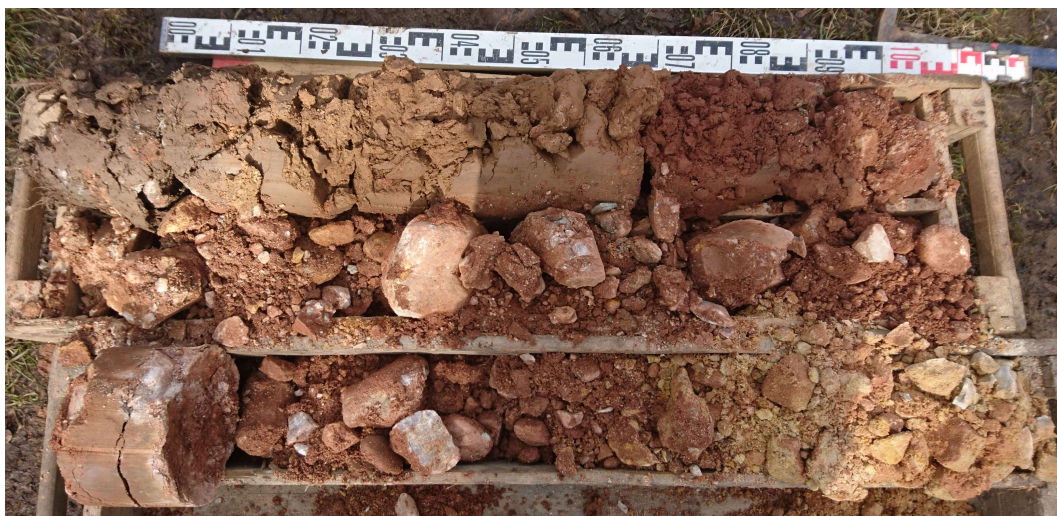
Vrtné jádro průzkumného vrtu V-110
