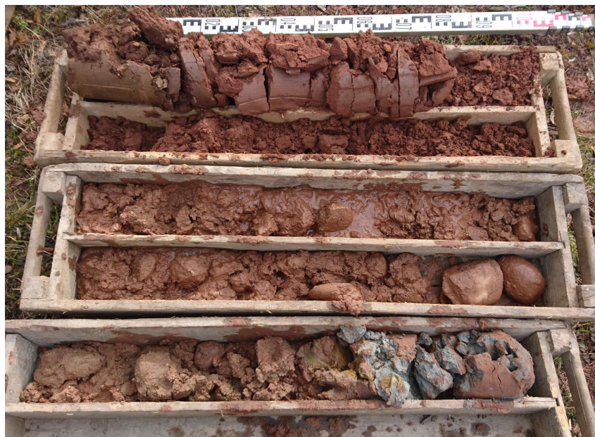
Vrtné jádro průzkumného vrtu V-103
