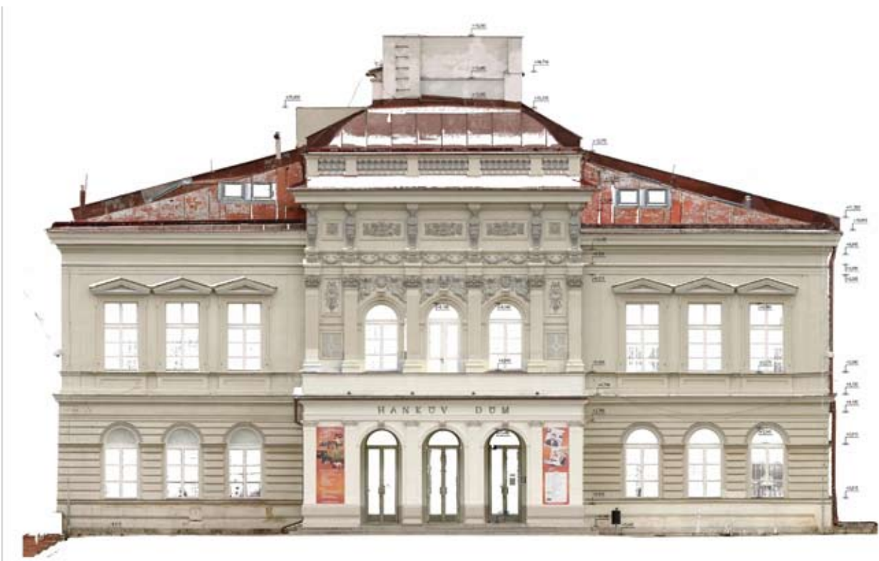
Obr. 62: Laserové zaměření jižní fasády Hankova domu, M 1:200 (Kudrnovský, 2014).
