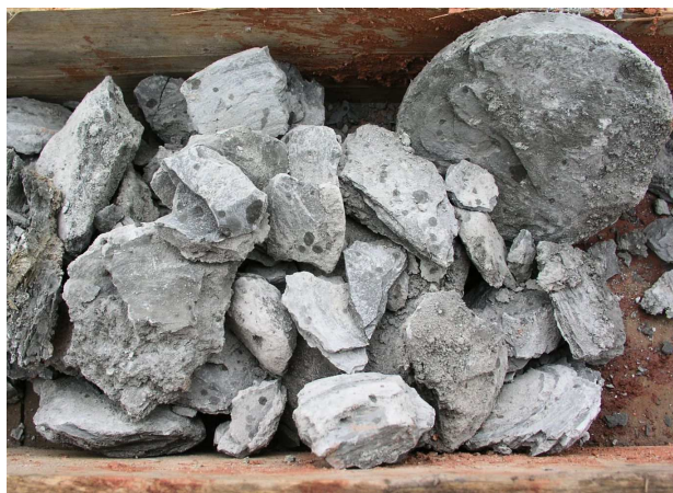
Vrt J 6: Mírně zvětralý slínovec z hl. 6 - 6,2 m = 0,5 m pod povrchem skalního podloží
